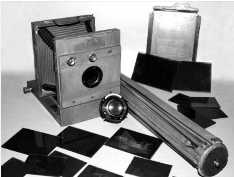
Eine solche Kamera benutzte einst auch Josef-Franz Engelmänn. Es handelt sich dabei um eine Plattenkamera der Marke „Union“, hergestellt bei Hugo Söcking & Co. in Dresden-Bodenbach um die Wende vom 19. zum 20. Jahrhundert. Das Objektiv dazu ist ein Tessar 1:6,3 von Carl Zeiss Jena. (Foto: Michael Vastag)
